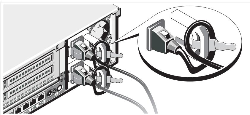
Fixez le support de fixation du câble sur la partie droite de la poignée du bloc d'alimentation. Faites une boucle comme indiqué dans l'illustration et insérez le câble d'alimentation dans le clip du support.
