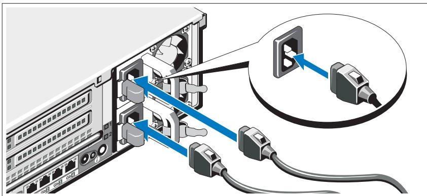
Conecte o(s) cabo(s) de alimentação ao sistema e, se for usado um monitor, conecte o(s) cabo(s) de alimentação ao monitor.
