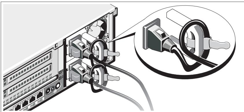
Conecte o suporte de retenção do cabo de alimentação na dobra direita da alça da fonte de alimentação. Curve o cabo de alimentação, conforme mostrado na ilustração e prenda-o ao gancho localizado no suporte.
